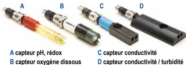
A capteur pH, rédox
