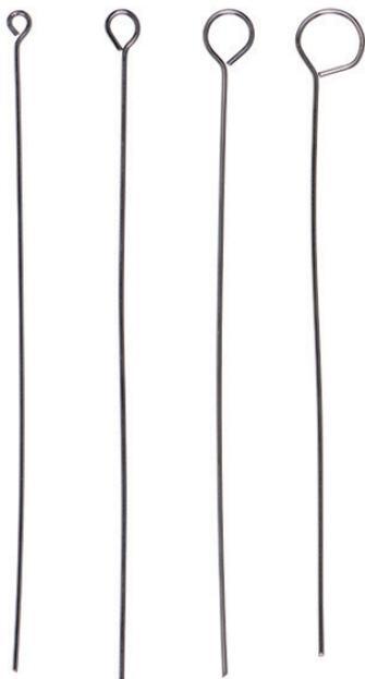
• le Contracid est un alliage spécial qui peut être porté à incandescence et remplace avantageusement le platine
